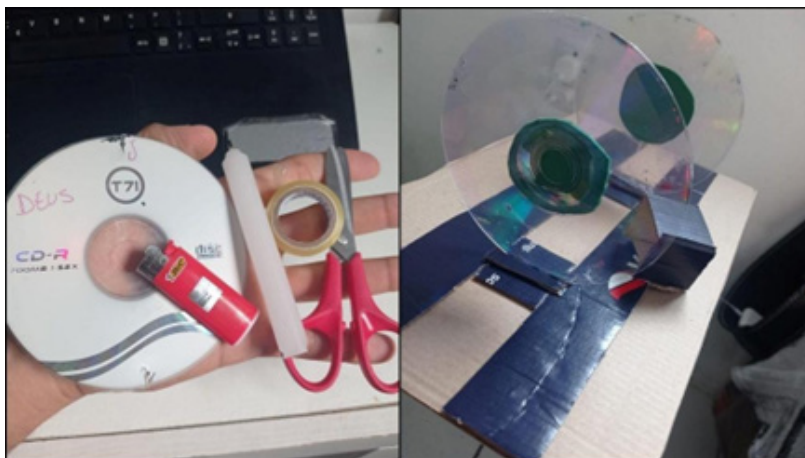
Figura 01 - Materiais e montagem do experimento da dispersão da luz
